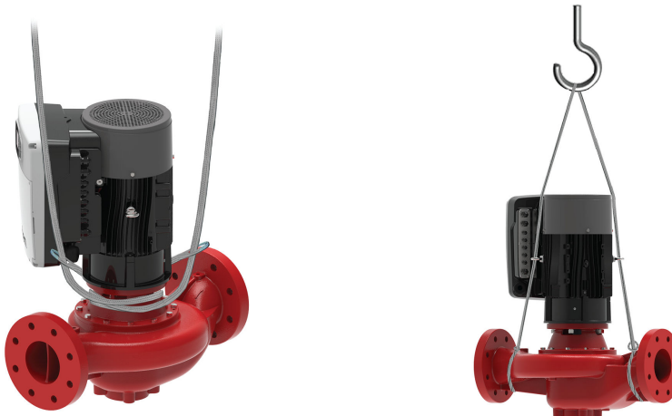
Métodos de elevación aceptables para los modelos de aspiración final con acoplamiento cerrado e-1531X y e-1532X
