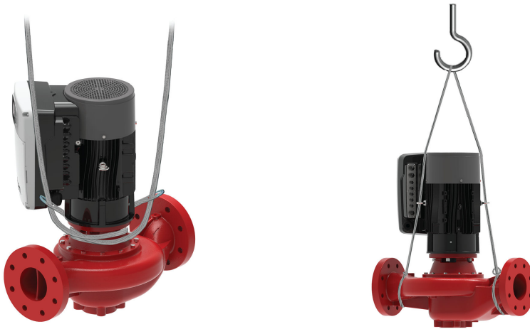
Méthodes de levage acceptables pour les modèles à aspiration directe e-1531X et e-1532X
