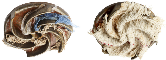
Abbildungen 6 und 7: Ansammlungen in einem Wirbelaufader
