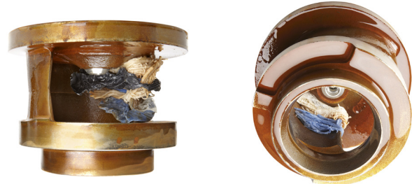
Abbildungen 4 und 5: Ansammlungen in einem Ein-Schaufel-Laufrad
