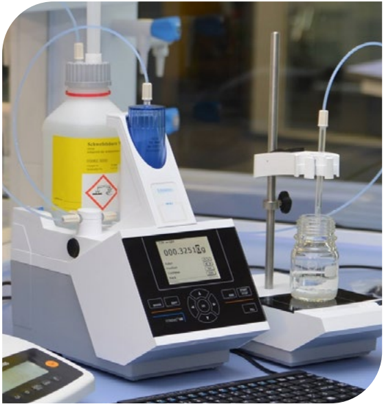
Abbildung 4: Xylem-Bürette Titronic® 500 zur Herstellung von Polyamidlösungen. Die Bürette ist mit speziellen Dosiereinheiten erhältlich, die für korrosive und hochviskose Lösungsmittel wie konzentrierte Schwefelsäure geeignet sind.
