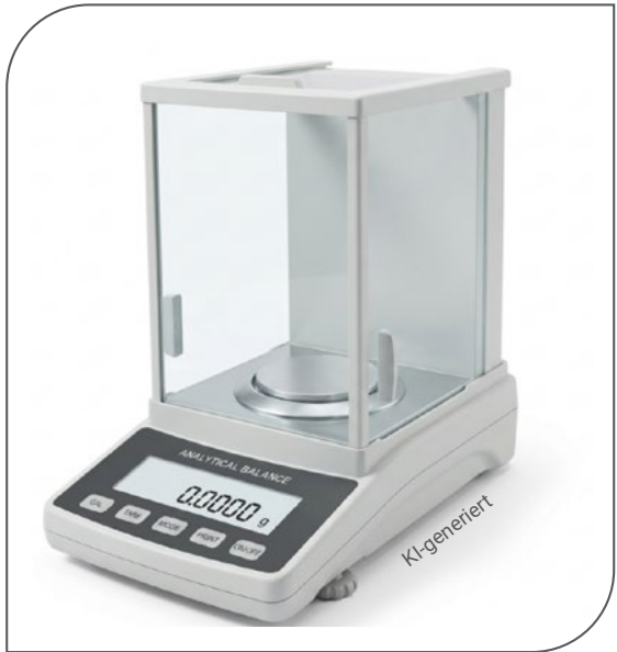
Abbildung 2: Typische Analysenwaage, die zum Abwiegen der Probenmenge bei der Viskositätsmessung in verdünnten Lösungen benötigt wird.
