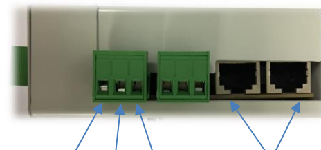
0V 24Vdc Abschirmung MODBUS-Kommunikationsschnittstelle 2 x 3-Wege-Stromversorgung 2 x RJ45-Steckerbuchsen
