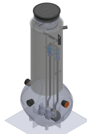
C-XL5P-DC-XXX-45/X Pumpbrunn Flygt Compit XL5-45. Höjd 4500mm för dn 50 pumpar. Vikt exkl. pumpar: Ca 420Kg Yttre volym ca: 4900L Produktkod: 01-45 90 29
