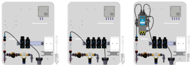
Trois variantes du panneau d'analyse de l'eau potable WTW: avec un nombre différent de cellules de débit et avec ou sans analyseur de turbidité.
